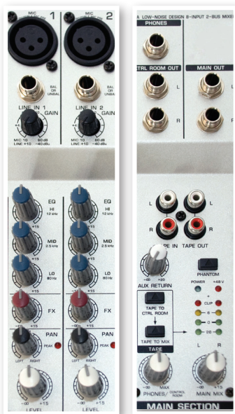
Figura 14 – Seção de entrada e seção do master e controle
