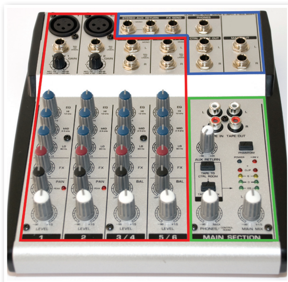
Figura 15 – Esquema das seções desta mesa (■ entrada; ■ saída; e ■ master/controlado)
